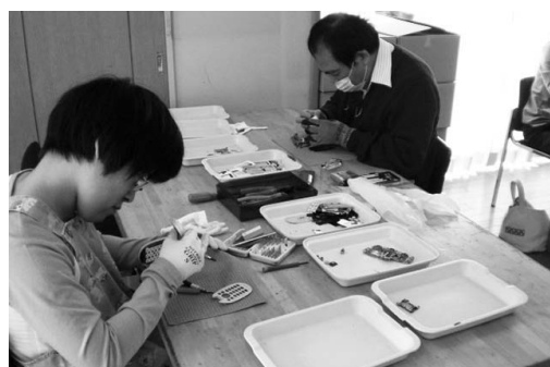
分解・分別作業の様子
